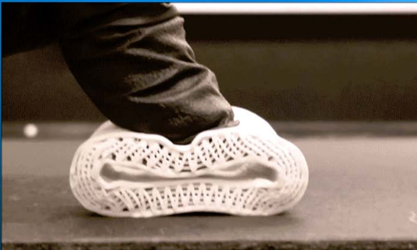
Elastyczny wydruk 3D struktury sztucznej kości
