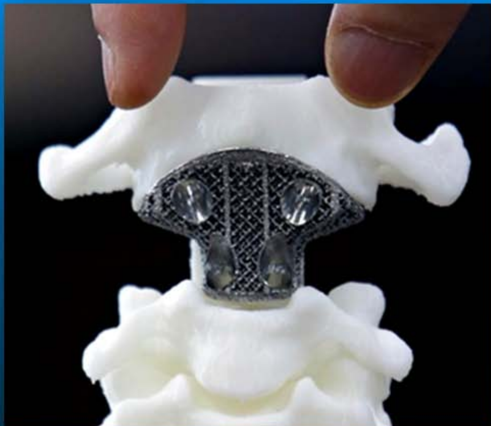
Tytanowe drukowane implanty struktur kręgosłupa
