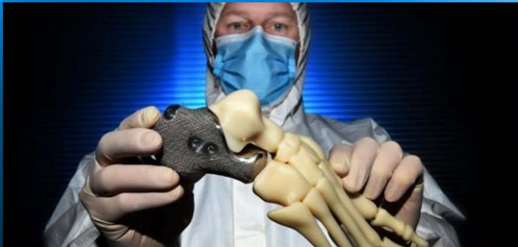
Tytanowe wydruki 3D ruchomych implantów struktur stawowych
